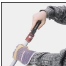
Snadné odhrotování pomocí rukojeti
